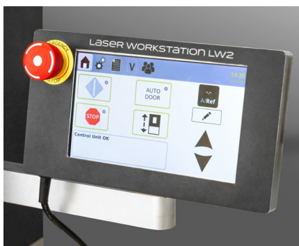
Intuitive Schnittstelle, Steuerung der Markierung mit Touchscreen
