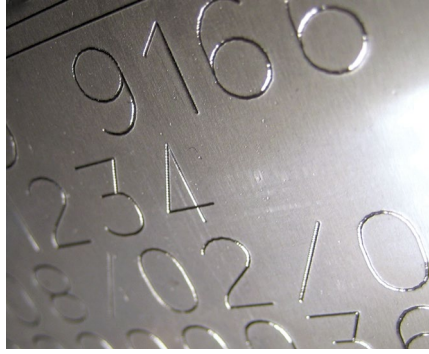
Markierung aus rostfreiem Stahl
